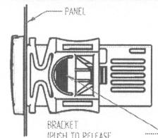
Regulátor XR06CX se montuje do panelu, do vyříznutého otvoru o rozměrech 29x71 mm a připevňuje pomocí speciálních úchytek, které je součástí dodávky.
