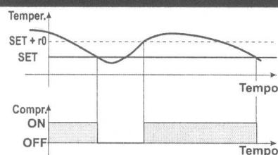
V případě poruchy čidla termostatu je okamžik startu a zastavení kompresoru určen parametry "Cy" a "Cn".
